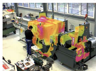
Estas cámaras duales térmicas ofrecen "thermal overlay" (superposición térmica) para identificar los llamados "hotspots" de forma visible en la imagen y así evitar daños mayores.
